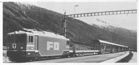
Fig. 2. — Composition navette pour le transport des automobiles.
