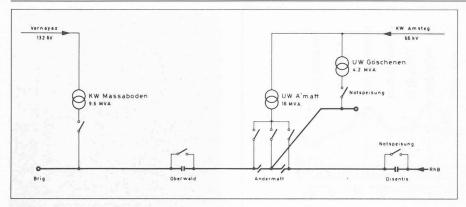
Fig. 6. — Schéma de l'alimentation électrique du Furka-Oberalp.
