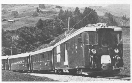
Fig. 3. — Composition réversible tractée par un fourgon automoteur Deh 4/41.
