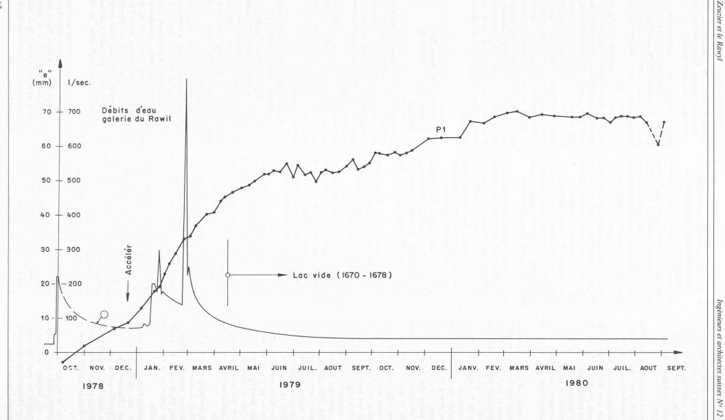
Fig. 5. — Rawyl. Excédent des déformations au couronnement du barrage, console M.
