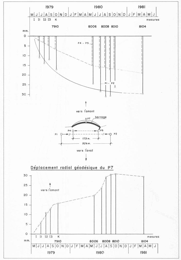
Fig. 7. — Diminutions des distances P1-P2 et P4-P5.
