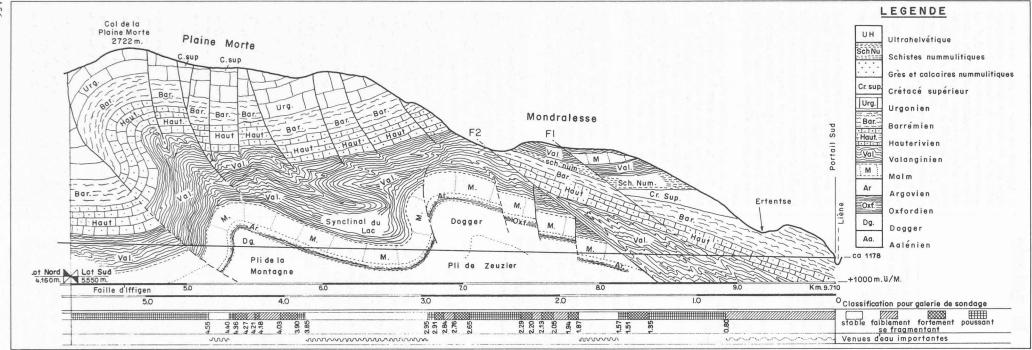
Fig. 1. — Tunnel du Rawyl. Coupe longitudinale provisoire.
