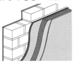
Voilà 18 années que le système calorifuge <u>rhodipor</u> est apprécié et qu'il tient ses promesses: protection calorifuge efficace, (lambda de calcul  $\lambda = 0.056$  W/mK), apparition d'eau de condensation inexistante,
