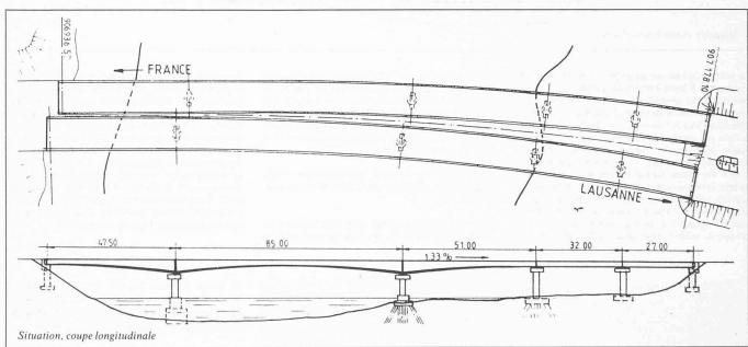
La conception de l'ouvrage est classique. Les câbles de précontrainte des éléments d'encorbellement sont disposés dans la dalle supérieure et ne descendent pas dans les âmes. Chaque voussoir est précontraint par 4 câbles de 158 t chacun. De plus, les câbles longitudinaux sont disposés dans la dalle inférieure, en travée. L'épaisseur constante des âmes de 32 cm est faible. Il serait souhaitable de précontraindre les chevêtres et de modifier leur forme.
