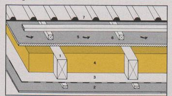
**Fig. 1 Montage d'une sous-toiture (ISOROOF)**1Chevron, 2 Plafond, 3 Pare-vapeur, 4 VETROFLEX ROLLALU,
