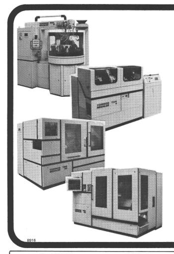
**ROL 8** machine transfert modulaire à haute production pour pièces  $\varnothing$  max. 7 mm, à 8 év. 11 positions
