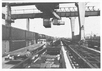
Fig. 8. — Pont roulant de 40 t sur 10 voies de circulation au terminal intermodal de Milan-Rogoredo.
