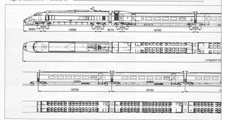
Fig. 12. — Disposition générale d'une rame TGV.
