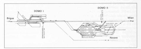
Fig. 6. — Schéma des futures installations de Domodossola.
