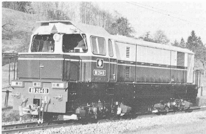
La nouvelle locomotive à crémaillère et adhérence HGm 4/6 lors des épreuves pratiques sur un tronçon du chemin de fer appenzellois.
