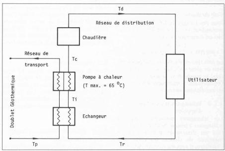
Fig. 1. — Schéma des éléments du système avec indication des températures. Tp = température fluide en tête de puits; Td = température départ chauffage; Tr = température retour chauffage; Ti = température intermédiaire entre échangeur et pompe à chaleur; Tc = température à la sortie de la pompe à chaleur ( $\leq T_{max}$ ).
