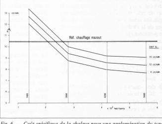
Fig. 6. — Coût spécifique de la chaleur pour une agglomération du type WE-20-A en fonction du prix de l'électricité. Chauffage avec pompe à chaleur; eau géothermique à 50 °C.
