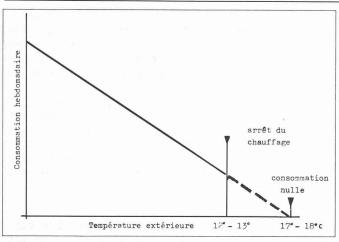
Fig. 3. — Enclenchement en fonction de la température extérieure.
