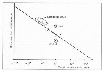
Fig. 5. — Influence d'anomalies sur le fonctionnement.
