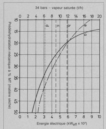
Exemple des données d'exploitation d'une station d'incinération des boues d'épuration des eaux usées pour 360 000 de population équiva-
