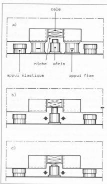
Fig. 5.— Système d'appuis du banc d'essais. Le banc étant sur ses appuis fixes (a), la mise sur appuis élastiques se fait en trois phases: 1. Le levage à l'aide des 6 vérins actionnés par un système hydraulique synchronisé (b). 2. Le retrait manuel des appuis fixes (b). 3. L'abaissement sur les appuis élastiques par relâchement de la pression dans les vérins (c). Dans cette position, le banc est situé environ 10 cm plus bas que le niveau fini du sol de la halle.
