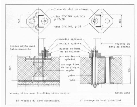
Fig. 8. — Détails des systèmes d'ancrage des bancs d'essais.
