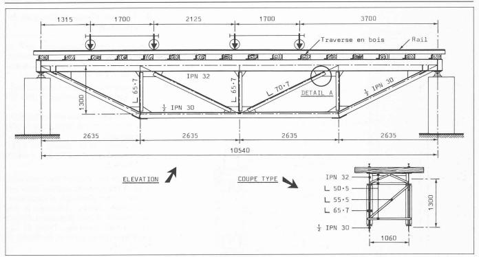
Fig. 11. — Pont de chemin de fer SZB. La position des essieux correspond ici à celle qui a été adoptée dans l'essai de fatigue et qui provoque les contraintes maximales dans la diagonale (DETAIL A).
