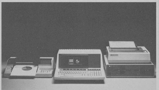
Un système complet élaboré autour du nouvel ordinateur HP-87, comprenant la nouvelle table traçante HP 7470 (à gauche), une unité pour deux disques et une imprimante HB 82905B.
