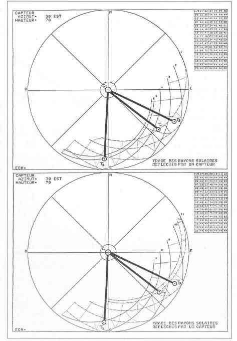
Fig. 8. — Report des points  $T_1$ ,  $T_2$ ,  $T_3$  sur les graphiques correspondant à des capteurs orientés  $30^{\circ}$  Est et inclinés à  $70^{\circ}$ .
