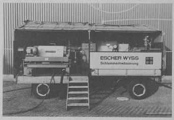
Fig. 2. — Installation pilote mobile pour l'étude des boues d'eaux usées en service en Espagne.
