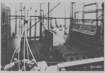
Installation d'osmose inverse (à droite) et d'échangeur d'ions (à gauche).
