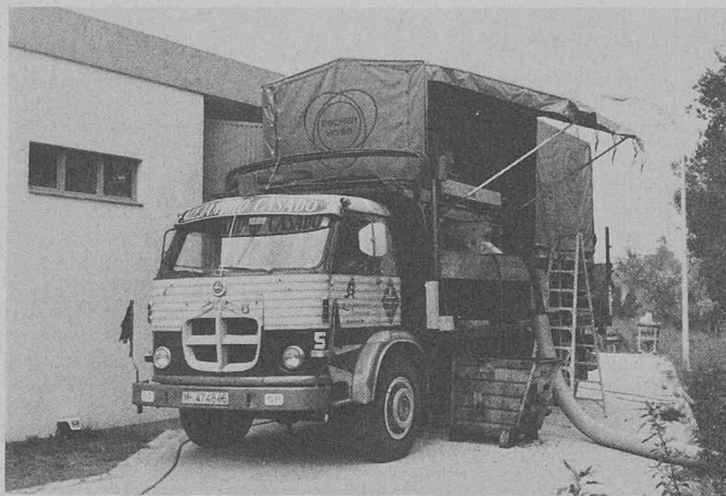
Fig. 1. — Installation pilote mobile de déshydratation de boues prête à fonctionner dans une entreprise industrielle.
