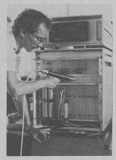
Système de réception électronique ÉLAB: unité centrale surmontée du testeur d'allumage en cours du test d'échauffement et de perturbation radioélectrique.
