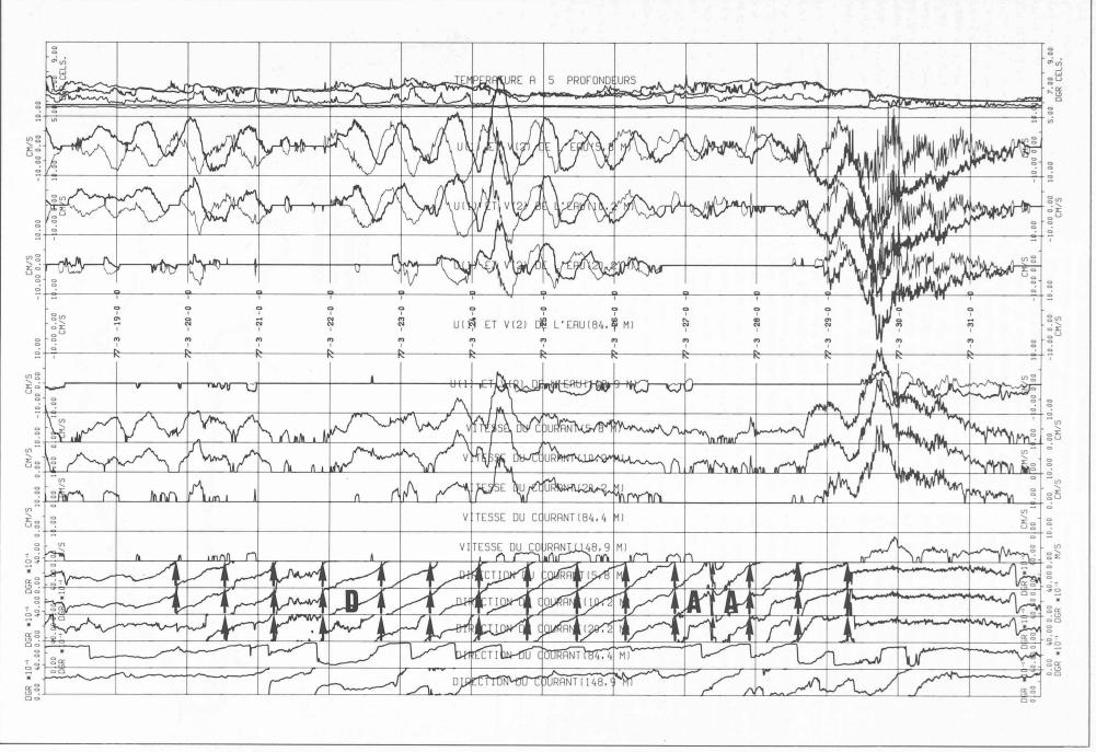
Représentation analogique des mesures de température et de courants à Saint-Sulpice du 18 au 31 mars 1977. Fig. 5.
