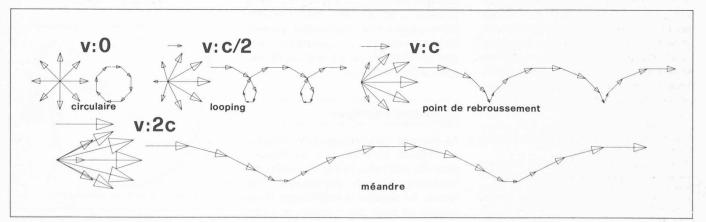
Fig. 3. — Différents modèles de courants obtenus par superposition d'un mouvement d'inertie et de mouvements uni-directionnels. En haut à gauche est représenté le vecteur rotatif à vitesse constante c. Les superpositions de ce courant rotatif avec différents courants unidirectionnels à vitesse variable, v, sont dessinées soit à l'aide de vecteurs de même origine soit à l'aide d'hodographes intégrés (d'après fig. 78 de Mortimer) [13].
