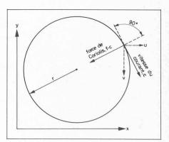
Fig. 1. — Courant d'inertie dans le plan horizontal (x, y). Les rélations entre vitesse de courant (c, composantes u et v), force de Coriolis (f·c), et résultante circulaire (rayon r) sont données dans le texte.
