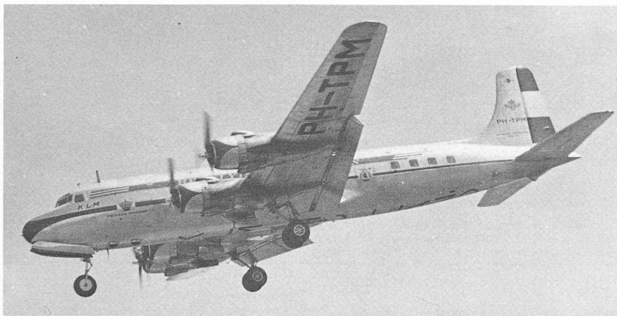
Fig. 7. — Comme le DC-1, le DC-4 s'est révélé capable de développements conduisant à la naissance de toute une série de types. Ici, le DC-6A, à cabine pressurisée. (Photo J.-P. Weibel)
