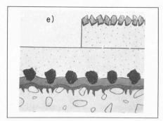
Fig. 16. — e) l'asphalte coulé s'accroche aux granulés de caoutchouc.
