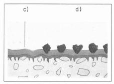
Fig. 13. — c) l'étanchéité néoprène s'adapte à la surface et adhère fortement au primer; d) les granulés de caoutchouc servant de liaison pour le revêtement routier sont épandus sur la dernière couche d'étanchéité néoprène.
