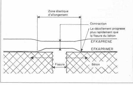
Fig. 14. — Représentation schématique du pontage d'une fissure.
