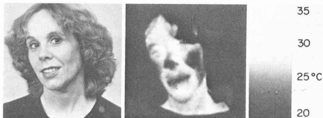
Le thermogramme restitue les zones chaudes (orbites des yeux par exemple) en tons clairs, les zones froides (cheveux, pullover ou nez, ce dernier étant refroidi par la respiration) en tons foncés.
