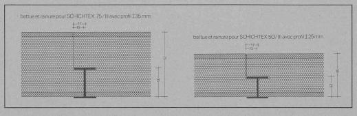
une plaque en stratifié également comme revêtement inférieur. L'âme est en polystyrène. Les panneaux comportent une battue sur tout le pourtour et un double recouvrement de 6 cm de haut et sur les côtés. Ils sont livrables en épaisseurs de 80, 105 et 125 mm. Une nouveauté: les panneaux stratifiés apparents avec revêtement pelliculaire sur la face visible.
