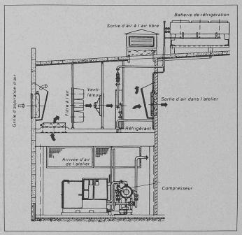
Fig. 3. — Schéma de principe d'un compresseur refroidi à l'eau. L'eau de refroidissement réchauffée en provenance du compresseur est pompée à travers un échangeur de chaleur air/eau, lequel réchauffe l'air utilisable ensuite pour le chauffage. En été, cet air est évacué par le toit à l'air libre. En hiver, l'air de l'atelier arrive dans le local du compresseur, absorbe tout d'abord la chaleur du moteur, passe par l'échangeur de chaleur et retourne dans l'atelier.
