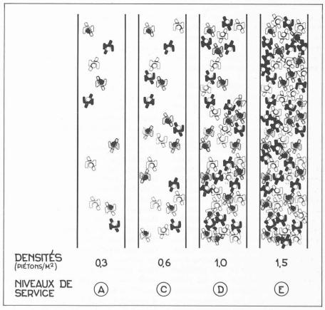
Fig. 3. — Visualisation de densités d'écoulement de flux piétonniers.
