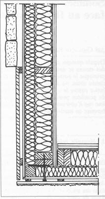
Coupe horizontale: variantes de fi-Fig. 6. nition de la façade et connection d'angle.
