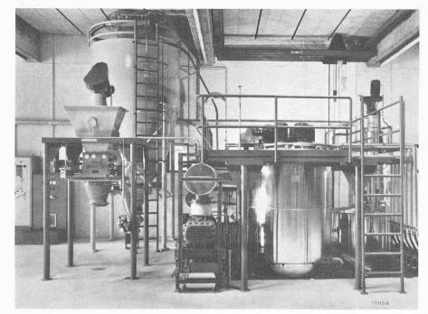
Fig. 5. — Séchage des boues par le procédé « Bühler ».
