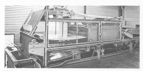
Fig. 7. — Filtre-presse «Squeezor», de Degrémont.
