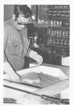
Fig. 6. — Remplissage du moule.
