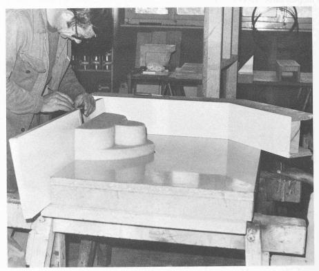
Moule adaptable pour les arcatures en contre-plaqué stratifié, voûte en silicone souple.
