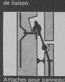
Attaches pour panneaux de parement
