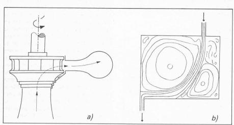
Fig. 1.a) — Ecoulement au travers d'une pompe et fuite par le joint labyrinthe. Fig. 1.b) — Lignes de courant observées dans un modèle agrandi fixe d'une chambre de labyrinthe.
