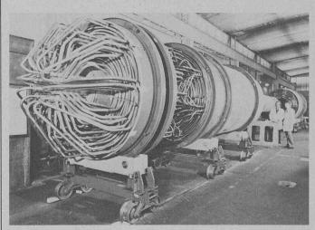
Vue d'un générateur de vapeur d'un réacteur au thorium à haute température du côté entrée de l'hélium. Au premier plan, faisceau de resurchauffeur avec tubes de liaison; à l'arrière-plan, faisceau de surchauffeur.
