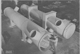
Deux des quatre échangeurs de chaleur pour le refroidissement du circuit intermédiaire dans un réacteur à eau bouillante (matériau des tubes: CuZn28Sn; surface de refroidissement par unité: 73 cm²).
