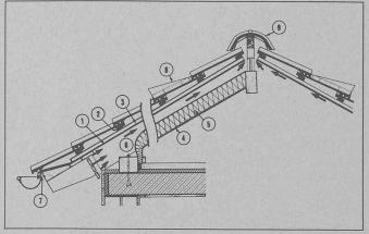
Pour bien fonctionner, le matériau (1) a besoin d'aération. Sous le lattage (2) du toit, celle-ci est assurée par des contre-lattes (3) et en dessus de la barrière-vapeur (4) et l'isolation thermique (5) par des chevrons (6). L'air circule à partir de la gouttière (7) sur les deux faces du matériau et sort par des chatières (8) ou par la faîtière (9).
