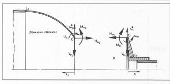
Fig. 17. — Efforts et déplacements au raccord (point 0).
