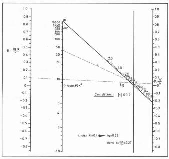
Fig. 13. — Méthode par amortissement: diagramme «t».
