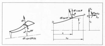
Fig. 15. — Action de la pression sur un élément de coque.
