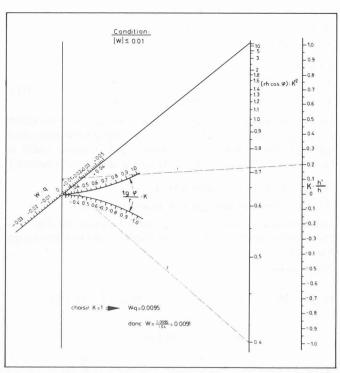
Fig. 14. — Méthode par amortissement: diagramme « W ».
