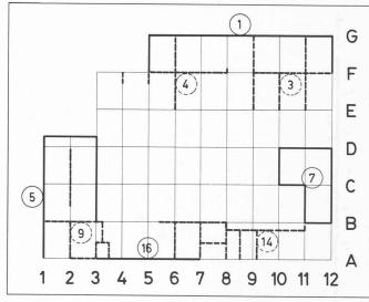
Fig. 10. — Etapes de bétonnage des murs.
