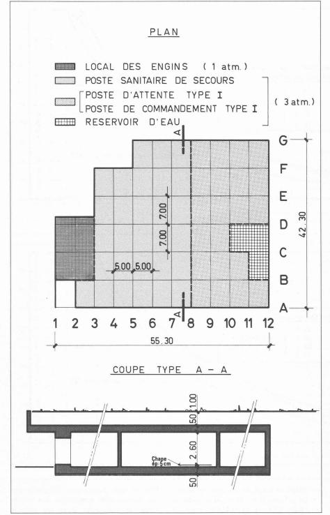
Fig. 1. — Plan avec indication de la répartition des locaux; coupe type dans son état final.
