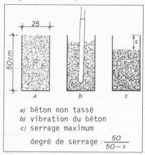
Fig. 4. — Mesure du degré de serrage.
