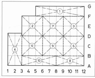
Fig. 9. — Etapes de bétonnage radier + dalle.
