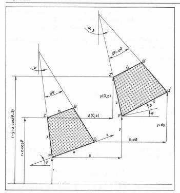
Fig. 4. — Déplacements d'un élément de coque dans son plan méridien.
