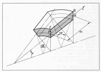
Fig. 3. — Elément de coque de révolution d'angle circonférentiel dψ.
