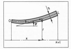
Fig. 1. — Coupe méridienne d'un élément de coque de révolution.
