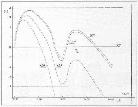
Fig. 2. — Respiration de l'interface de la cagnotte (séparation entre partie supérieure chaude et partie inférieure froide), contenance de 75 m³, puisage journalier de 250 m³ et pour 4 températures de condensation.
