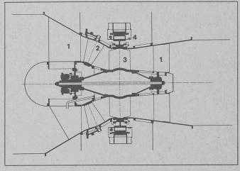
Schéma de l'installation de turbine Straflo pour Andenne (B). 1. Appui de paliers. Aubes directrices orientables. 3. Roue motrice. 4. Alternateur.
