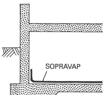
Monocouche d'étanchéité à base de bitume
