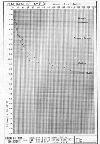
Fig. 8. — Résultats des sondages au pénétromètre.
