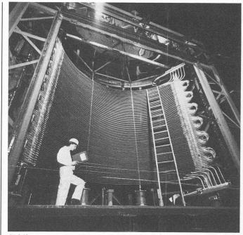
93 héliostats commandés par ordinateur focalisant les rayons solaires sur ce récepteur.
