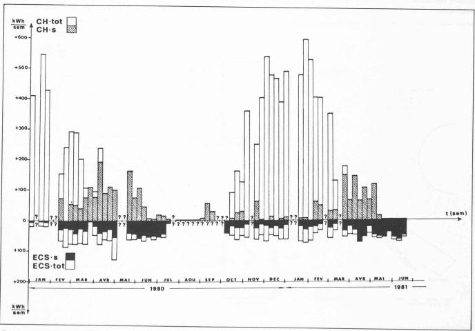
Fig. 4. — Evolution de la couverture solaire des besoins en chauffage (vers le haut) et en eau chaude sanitaire (vers le bas) pas semaine.
