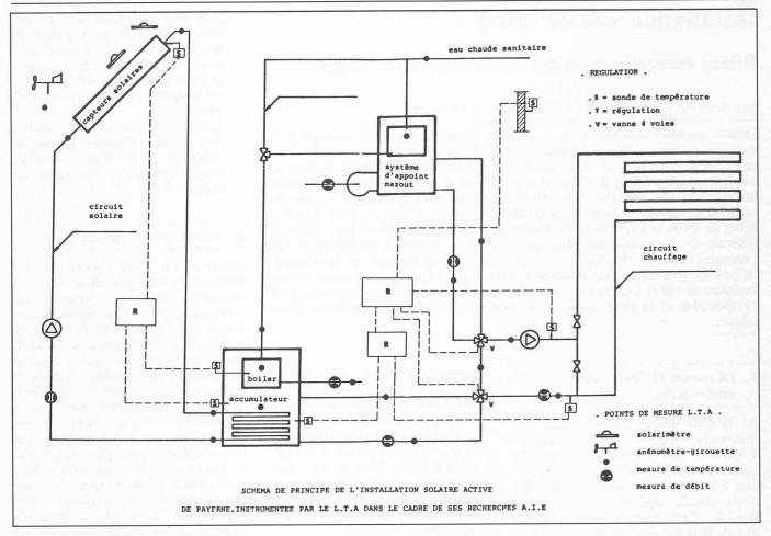
Fig. 2 — Schéma de principe de l'installation.
