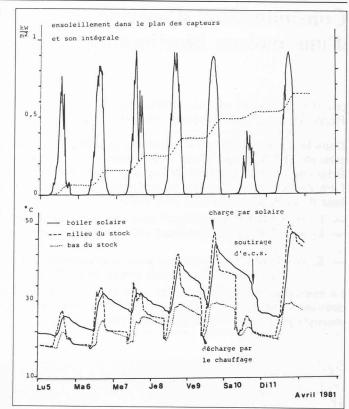
Fig. 6 et 7. — Evolution de l'ensoleillement et des températures mesurées dans le stock solaire pour 2 semaines différentes en janvier et en avril 1981. Remarquer les échelles de températures différentes.
