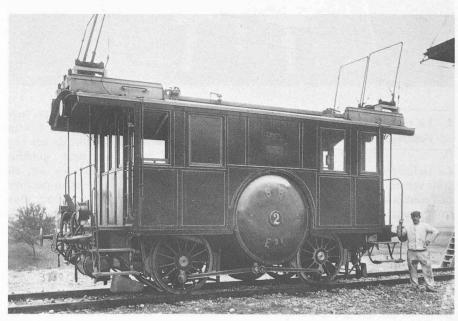
Innovation au bénéfice de tous: la première locomotive électrique de ligne en Europe (1899; Berthoud-Thoune) Deux moteurs BBC triphasés de 150 ch (750 V; 40 HZ), vitesse maximale; 45 km/h. (Photo BBC)
