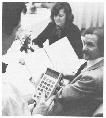
Grâce à ce terminal portatif, le serveur transmet sans fil à la cuisine et au bar les commandes des clients, qui sont simultanément mémorisées par un ordinateur pour calculer l'addition. Des collecteurs logés au plafond captent le rayonnement (Photo Siemens)
