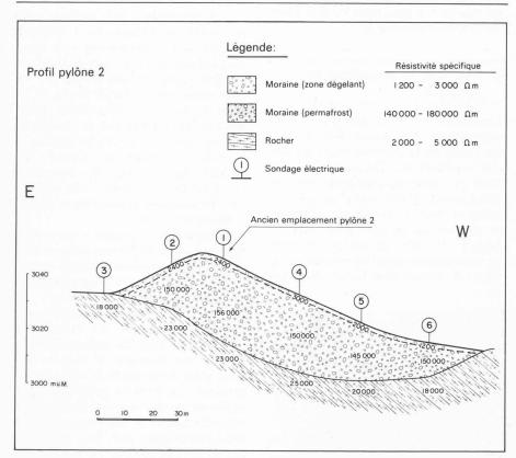
Fig. 3. — Pylône 2, profil géoélectrique.
