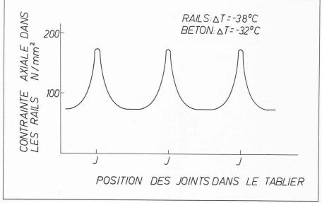
Fig. 8. — Variation des contraintes axiales dans les rails du viaduc de Westmont pour les conditions d'ancrage réelles.
