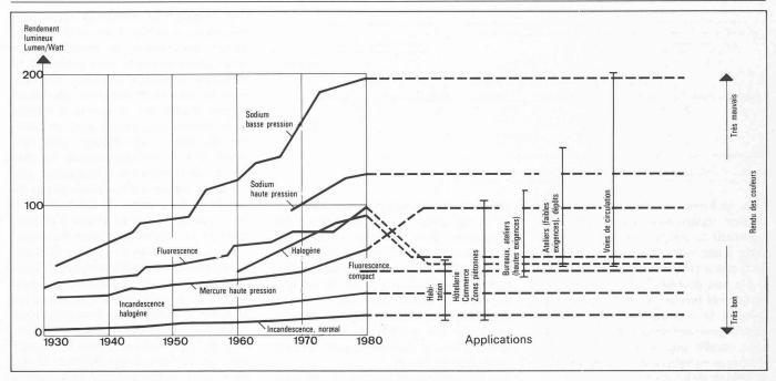
Fig. 1. — Augmentation du rendement lumineux de divers types de lampes entre 1930 et 1980.
