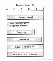
Fig. 6. — Influence sur le besoin en énergie annuel de chauffage des mesures prises (bâtiment administratif).
