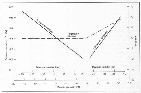
Fig. 7. — Puissance de chauffage et de refroidissement requise (bâtiment administratif).
