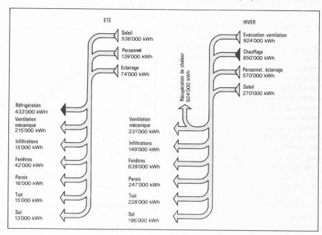
Fig. 11. — Diagramme des flux énergétiques (bâtiment administratif).
