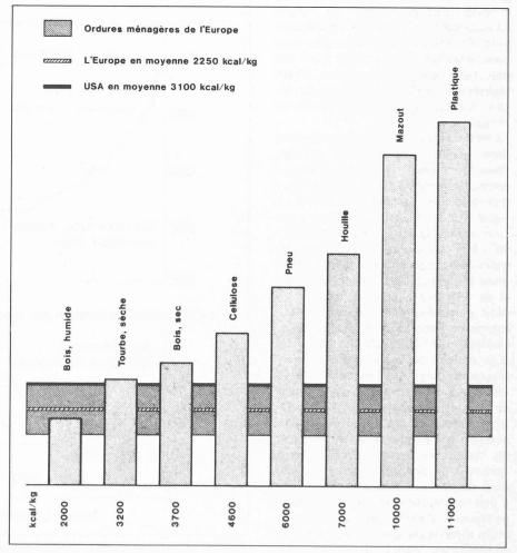
Fig. 1. — Comparaison du pouvoir calorifique des ordures à celui de sources d'énergie conventionnelles.
