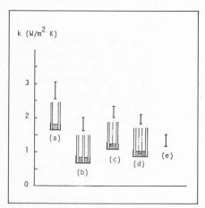
Fig. 4. — Valeur k (W/m²/K) de divers systèmes de vitrage: a) vitrage double; b) vitrage triple; c) vitrage double avec feuille de plastique intermédiaire; d) vitrage double avec feuille de plastique réfléchissant l'infrarouge.
