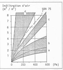
Fig. 2. — Résultats de calfeutrement d'une fenêtre: a) bande tubulaire; b) bande à section en V; c) bande étirée; d) bande de mousse en fibres.
