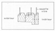
Fig. 9. — Principe d'adjonction d'une vitre intérieure sur une fenêtre existante.
