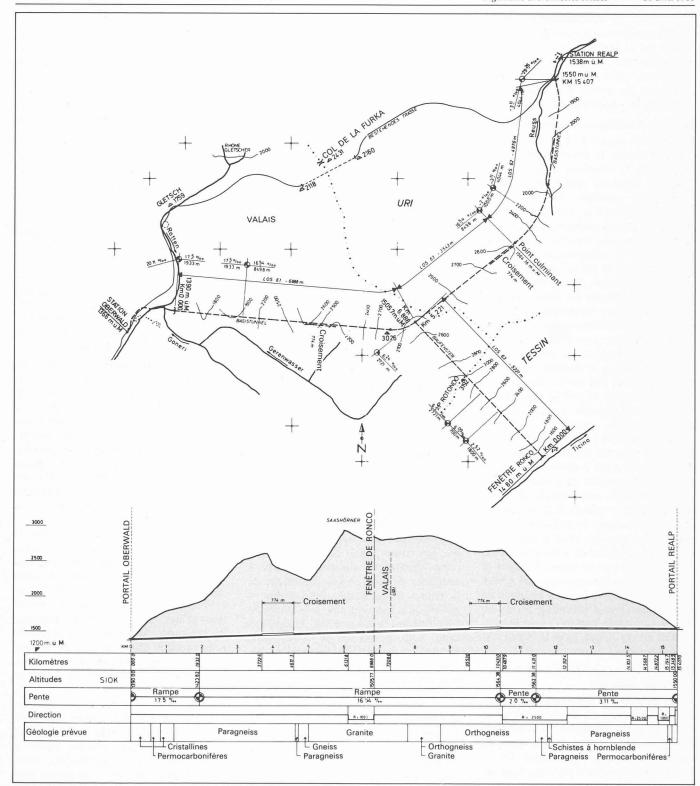
Fig. 2. — Situation et profil du tunnel de base.
