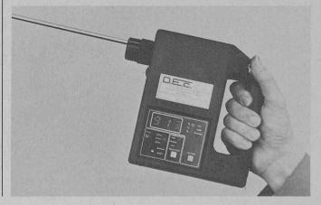
chauffe et le pourcentage d'oxygéne ambiant. Il contient également les données nécessaires pour tenir compte du combustible utilisé, que ce soit le mazout, le gaz naturel ou le charbon. Des abaques donnent les valeurs pour l'air propané et le gaz de craquage, le pourcentage de CO2 pour les comparaisons éventuelles et l'excès d'air insoufflé.
