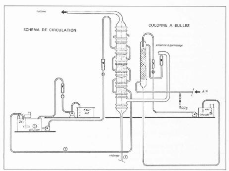
Fig. 3. — Schéma de circulation. Afin d'éviter toute évaporation sur le plateau inférieur de la colonne à bulles par le gaz entrant, on sature et thermostatise ce dernier par contact avec de l'eau chaude dans une petite colonne à garnissage.
