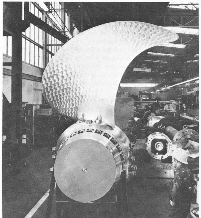
Une autre hélice à pales orientables en cours de montage.
